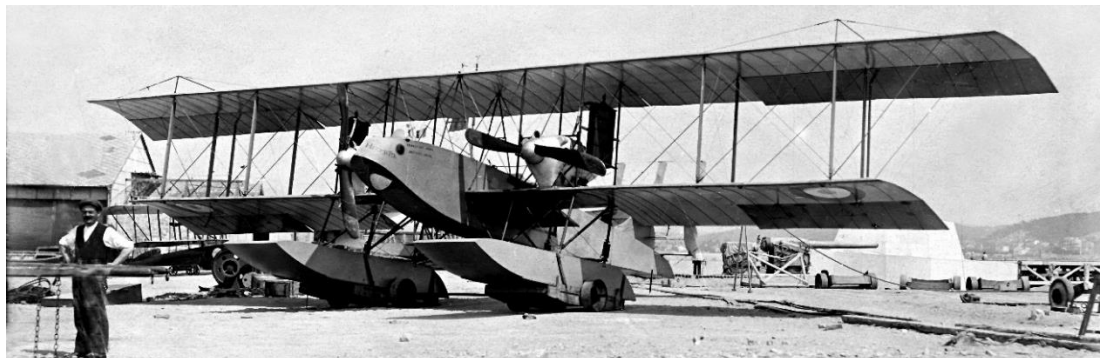
Hydravion Borel-Odier BO.2 équipé de 2 moteurs de 220 ch.
