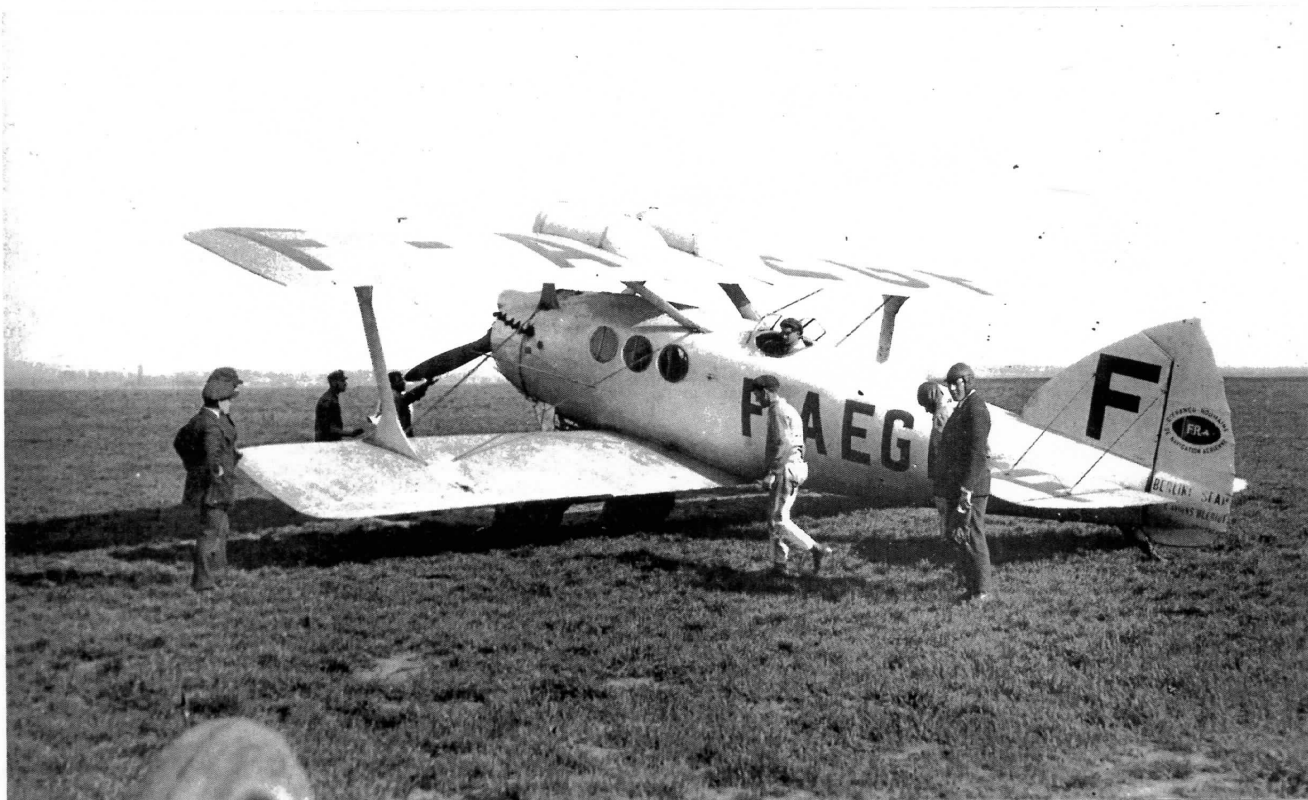
SPAD 46 n°23 F-AEGF – construit en 1922. Lorraine de 370ch. Modifié SPAD 66 en 1925 Terrain d'Aspern (Vienne) en 1922. Equipage Thuau, Libert, Martel. (archives Air France n°635/7)
