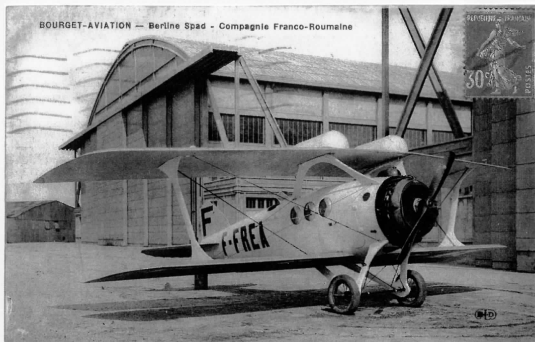
Le SPAD 33, construit par Blériot, équipé d'un moteur Salmson de 260 ch., avait une vitesse de croisière de 145 km/h et une autonomie de 600 km. Il pouvait transporter 4 passagers. La C.F.R.N.A. reçoit une livraison de 20 SPAD 33 à partir de mai 1921. Pour compléter la flotte, la CIDNA rachètera trois autres appareils à la Belgique en 1926. Fin 1924, onze SPAD 33 étaient encore en service à la CFRNA.
